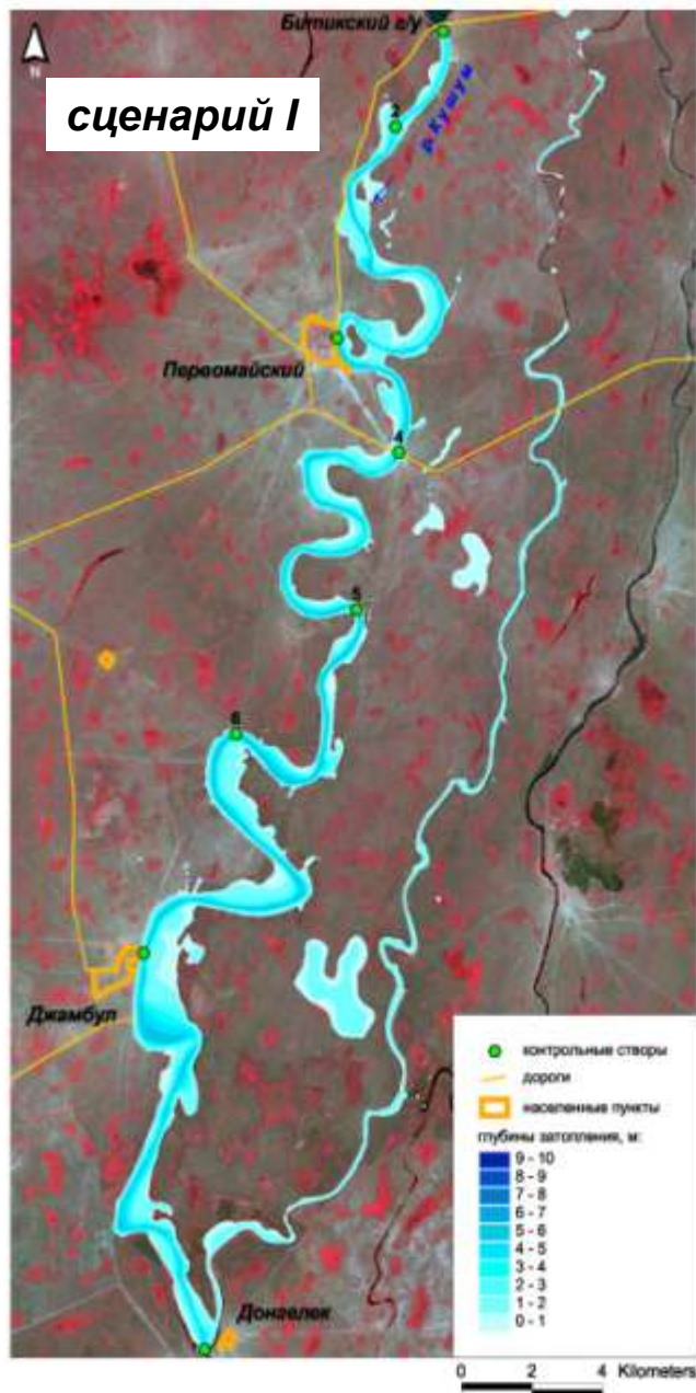
Глубины затопления долины р.Кушум при прорыве плотины Битикского водохранилища для основных сценариев аварии. Время после начала аварии: 36 часов
